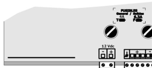
Es necesario incluir en la instalación un interruptor magnetotérmico de 6 amperios que, marcado como dispositivo de desconexión, esté próximo al equipo y accesible por el usuario.
