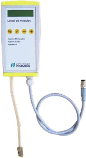
Los transmisores salen generalmente configurados de fábrica. No obstante, es posible realizar consultas o configuraciones mediante el uso de un “Lector de Módulos”, consistente en una pantalla y cuatro teclas que se conecta al transmisor mediante el único conector visible en su interior.
