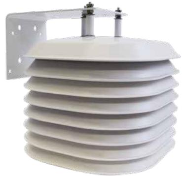
Realiza medidas de temperatura en rangos de -40 a 85 °C con una precisión de  $\pm 0,4$  °C y humedad relativa 0 – 100 % con precisión de  $\pm 3$  %. A partir de estos valores, entrega el valor calculado de Temperatura de Bulbo Húmedo ( $T_w$ ) en rango de -20°C a +20°C.
