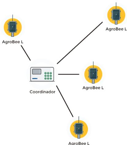
O seu baixo consumo permite-lhe operar com painel solar integrado no módulo e supercondensadores ou bateria (de acordo com modelo). O painel solar armazena a energia nos supercondensadores/bateria, oferecendo uma longa vida operativa. Só é necessário substituir as baterias nos modelos que incluem baterias no lugar de supercondensadores.
