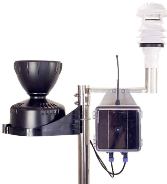
Módulo de rádio de muito baixo consumo e que faz parte do sistema AgroBee-L para a leitura dos sensores meteorológicos integrados numa estação.
