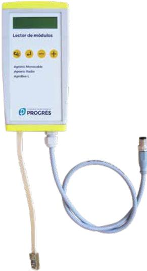
Do mesmo modo, um módulo deve ser configurado para comunicar com o Agrónic com o qual se queira associar. Para tal (se o módulo não estiver já configurado de fábrica) é necessário empregar o Leitor de Módulos (ou Leitor Agrónic Rádio, LAR) consistente num ecrã e quatro teclas que se conecta ao módulo AgroBee-L mediante o único conector no seu interior.
