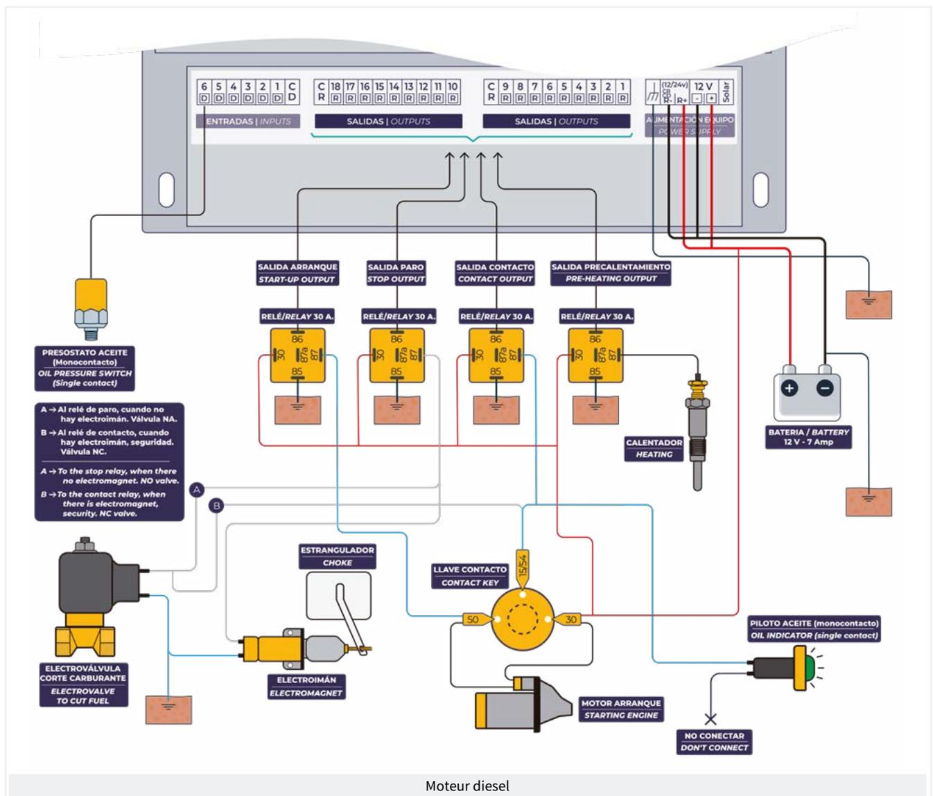
Si l'arrêt s'effectue par coupure du carburant au moyen d'une électrovanne, celle-ci doit être installée à l'entrée de l'injecteur de manière à ce que l'arrêt soit le plus rapide possible. Lorsque l'électrovanne est normalement **ouverte**, elle doit être connectée directement à la sortie d'arrêt. Lorsque l'électrovanne est normalement **fermée**, elle doit être connectée directement à la sortie de contact.
