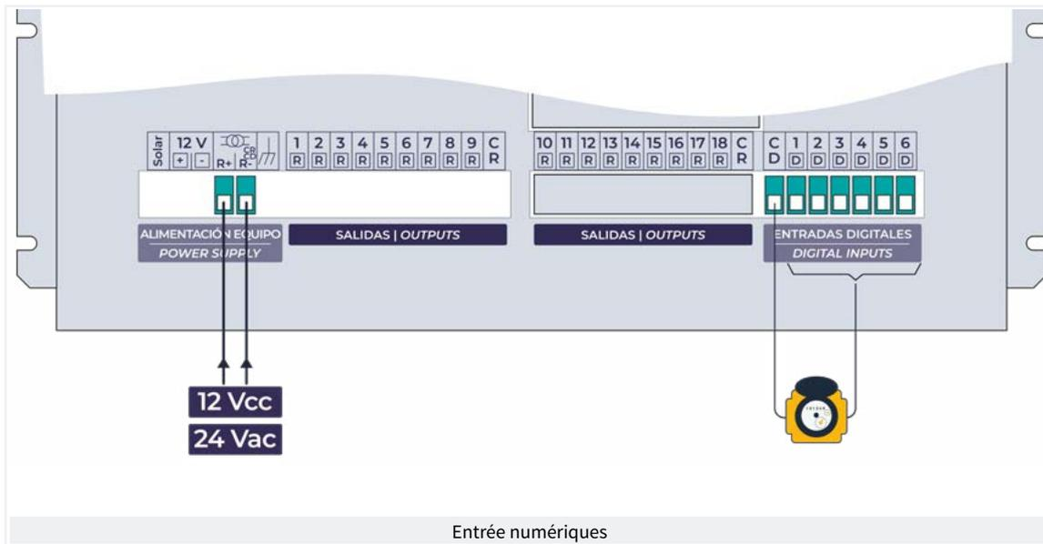
Les entrées numériques et les sorties de relais sont alimentées extérieurement à 12Vcc ou 24Vac.
