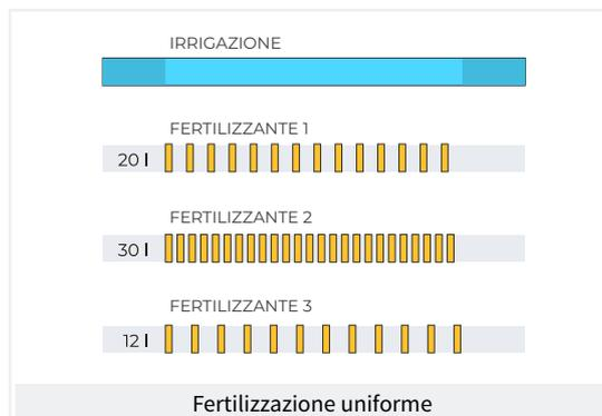
Nella fertilizzazione per volume, rilevamento della mancanza di impulsi o di perdite. Distribuzione proporzionale di ogni impulso del contatore negli accumulati e nelle cronologie, in base alla portata prevista dei settori che fertilizzano contemporaneamente. Fertilizzazione in parallelo.
