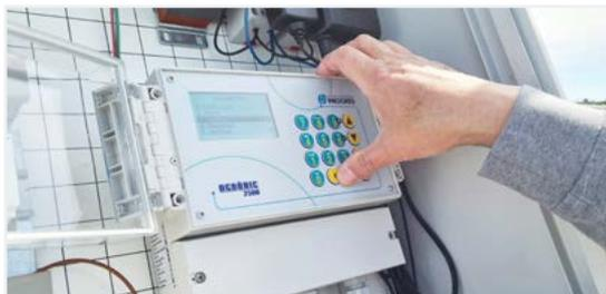
**Manual:** é qualquer ação que se deseje fazer de forma imediata. Por exemplo, ativar ou parar um programa, desativar um alarme, fazer uma paragem de emergência, etc.
