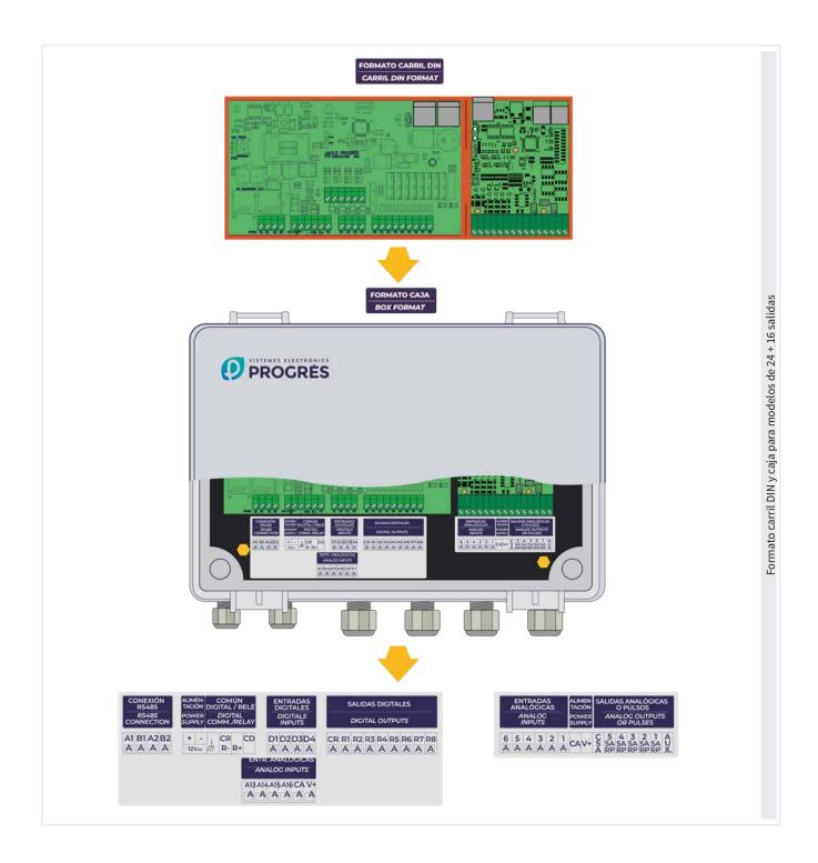
Para realizar la conexión entre el Agrónic 4500 y el módulo de expansión se usarán los pines 3(A) y 4(B) del conector marcado como "RS485 ME".
