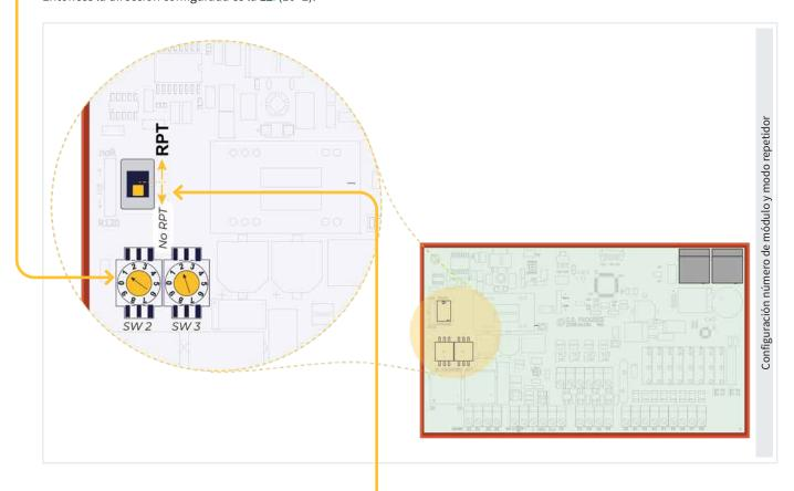
El interruptor (RPT) sirve para determinar si el modulo debe o no repetir la señal a otro módulo.
