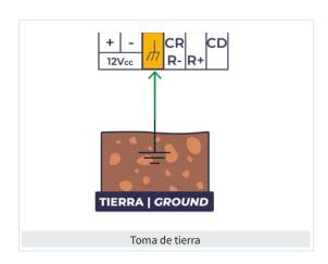
El borne de toma de tierra está situado junto a los bornes de alimentación; su función es la de dirigir a tierra las posibles chispas eléctricas generadas por tormentas y que puedan entrar por los cables de las entradas y salidas; el cebado del arco en el descargador de gas interno se produce a partir de 90 voltios.
