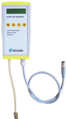
Da mesma forma, um módulo deve ser configurado para comunicar com o Agrónic ao qual se vai associar. Para isso (se o módulo não estiver configurado de fábrica), deve-se utilizar o Leitor de Módulos (ou Leitor Agrónic Radio, LAR) composto por um visor e quatro teclas, que se liga ao módulo AgroBee-L através do único conector visível no interior do módulo.
