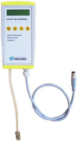
Da mesma forma, um módulo deve ser configurado para comunicar com o Agrónico ao qual se vai associar. Para isso (se o módulo não estiver configurado de fábrica), deve-se utilizar o Leitor de Módulos (ou Leitor Agrónico Radio, LAR) composto por um visor e quatro teclas, que se liga ao módulo AgroBee-L através do único conector visível no interior do módulo.
