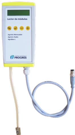
Da mesma forma, um módulo deve ser configurado para comunicar com o Agrónico ao qual se vai associar. Para isso (se o módulo não estiver configurado de fábrica), deve-se utilizar o Leitor de Módulos (ou Leitor Agrónico Rádio, LAR) composto por um visor e quatro teclas, que se liga ao módulo AgroBee-L através do único conetor visível no interior do módulo.
