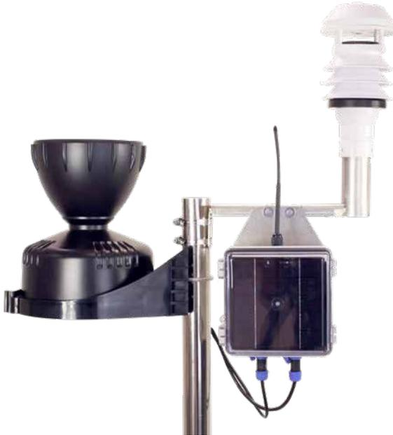
Módulo radio de muy bajo consumo e integrante del sistema AgroBee-L para la lectura de los sensores meteorológicos integrados en una estación.
