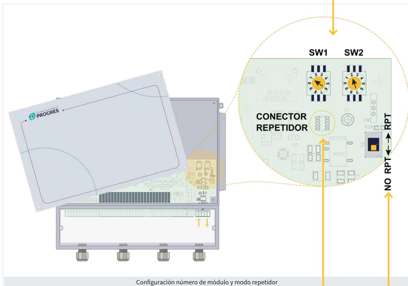
El interruptor (RPT) sirve para determinar si el modulo debe o no repetir la señal a otro módulo.
