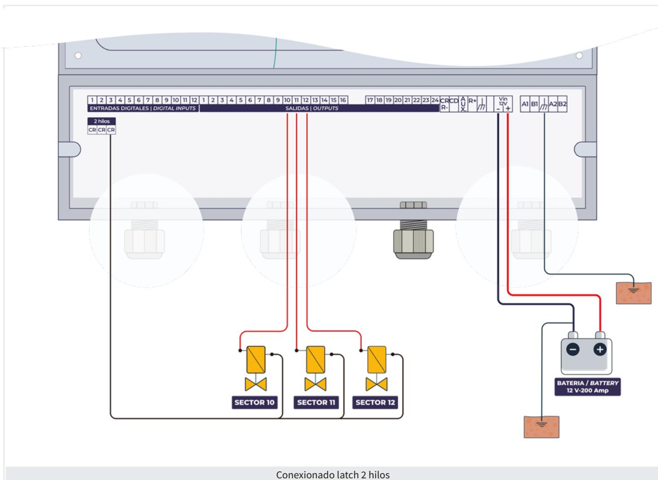
Uno de los dos cables se conectará al común de salidas ‘CR’ y el otro a la salida que le corresponda entre ‘R1’ a ‘R9’.
