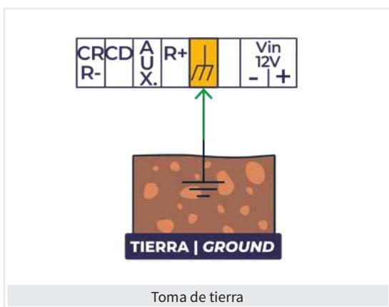
El borne de toma de tierra está situado junto a los bornes de alimentación; su función es la de dirigir a tierra las posibles chispas eléctricas generadas por tormentas y que puedan entrar por los cables de las entradas y salidas; el cebado del arco en el descargador de gas interno se produce a partir de 90 voltios.
