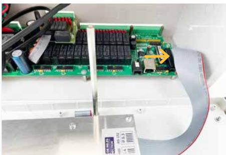
**8** Si el equipo llevaba la placa E/S analógicas, instalarla de nuevo tal y como se desmontado en el paso número 6. Hay que tener cuidado a la hora de conectar el zócalo de 28 pines de la placa E/S analógicas a la placa de relés ya que se puede romper algún pin.
