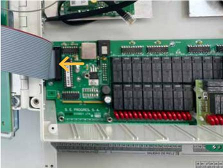
**8** Si el equipo llevaba la placa E/S analógicas, instalarla de nuevo tal y como se desmontado en el paso número 6.
