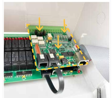
**7** Separar la parte del teclado del cajón tirando, con cuidado de la cinta plana gris que une las dos placas, y substituir por el nuevo frontal Agrónic 4500.
