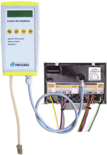
La configuración del MAM se realiza mediante el Lector Módulos, consistente en una pantalla y cuatro teclas. Para conectarlo no es necesario desalimentar el MAM. Para conectar el Lector Módulos al MAM encapsulado hay que desenroscar el tapón de protección del conector central.
