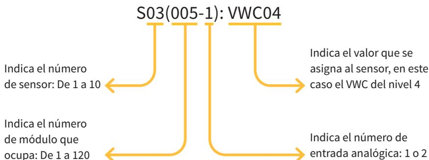
En este caso, para poder leer el sensor 3 del MAM 3-36 SDI, se debería asignar en el programador el módulo 5 y la entrada 1. Siendo el siguiente código el que se tiene que configurar: 07100501\*.
