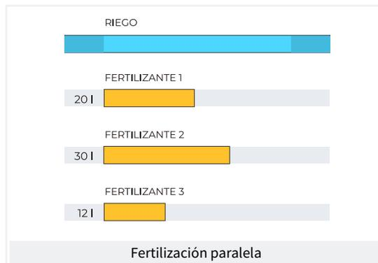
**Uniforme:** realiza la aplicación de los fertilizantes con un reparto uniforme de cada uno de ellos entre el pre y post riego.
