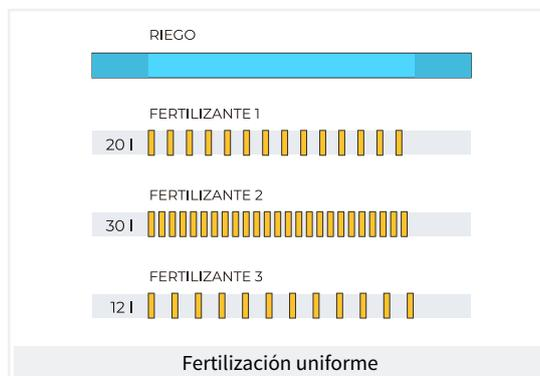
En la fertilización por volumen, detección de falta de pulsos o de fuga. Reparto proporcional de cada pulso del contador en los acumulados e históricos según el caudal previsto de los sectores que fertilizan a la vez. Fertilización en paralelo.
