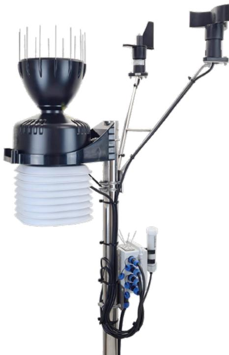
Estación que incorpora un conjunto de sensores climáticos: **humedad relativa, temperatura, radiación solar, anemómetro, veleta y pluviómetro.**
