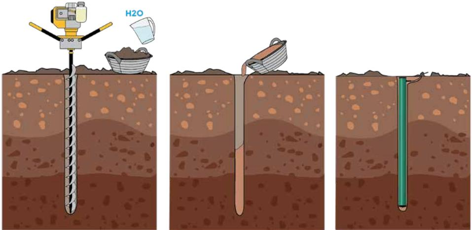
1. Con la ayuda de un ayoador taladrar el terreno en el punto donde se desea instalar la sonda. Es necesario utilizar una broca de diámetro 34 mm para maximizar el contacto con las paredes del suelo y procurar que la perforación sea lo más vertical posible.
