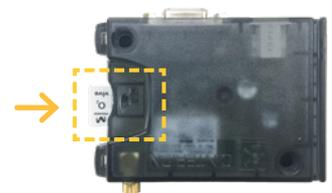
Si se utiliza una propia, desactivar el código PIN, quitar la tarjeta suministrada (presionar hasta escuchar un clic), e insertar la propia tarjeta, respetando el dibujo que está en el módem. Con la ayuda de un destornillador, presionar la tarjeta dentro la ranura hasta que se escuche un clic.
