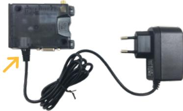
**3** Conectar el cable telefónico de tres metros (conector telefónico) al puerto RS232 del A7000 y (SUBD9) al módem.
