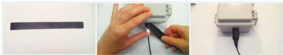
Una vez roscado el conector de la antena en el equipo, se empleará dicha cinta para aislar dicha conexión: esta conexión ya es estanca, pero este aislamiento adicional, añadirá una protección mayor en caso de que el módulo se moje accidentalmente.
