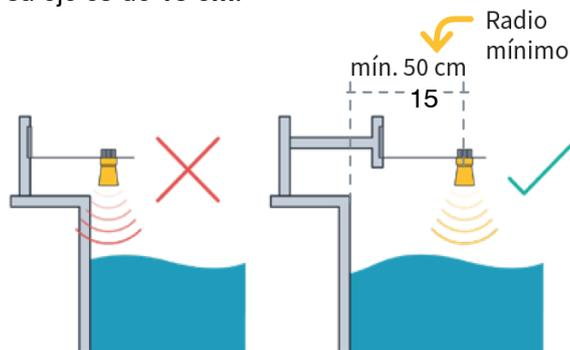
**NOTA:** El punto de referencia del sensor para medir distancias es el punto en el que se halla el soporte metálico suministrado, tal y como se indica en la figura.
