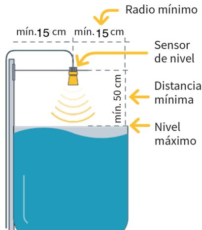
El sensor se suministra con una manguera de 7 metros que ya está conectada al transmisor, por lo que no es necesario realizar ningún tipo de conexión adicional. También se suministra un soporte para el sensor para facilitar la instalación de éste.
