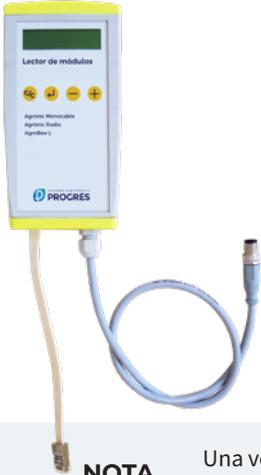
Del mismo modo, un módulo se tiene que configurar para comunicar con el controlador con el que se quiera asociar. Para ello (si el módulo no viene ya configurado de fábrica) hay que emplear el Lector de Módulos (ó Lector Agrónico Radio, LAR) consistente en una pantalla y cuatro teclas que se conecta al módulo AgroBee-L mediante el único conector visible en su interior.
