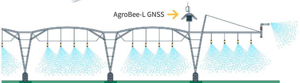
El módulo AgroBee-L GNSS está concebido para ser instalado encima de un mástil en la última torre del pívot, ya sea circular o lineal. En consecuencia, el módulo nos permite ubicar en un mapa cuál es la posición geográfica del pívot y cuál es su dirección de movimiento.
