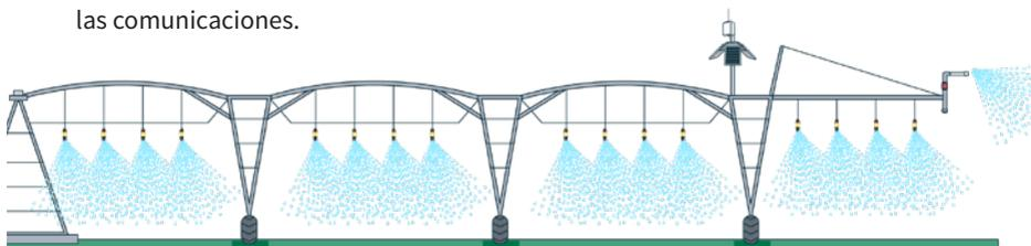
Para el correcto funcionamiento del sistema y para disponer de una buena comunicación radio es muy importante que el módulo GNSS se instalé sobre la última torre y al menos a 2 metros sobre la estructura metálica del Pivó. Con esto se consigue un correcto funcionamiento de la lectura de la posición y la comunicación entre el módulo GNSS y el Coordinador.
