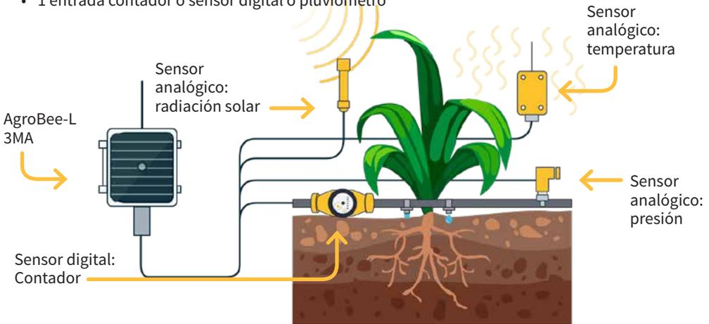
A modo de ejemplo, los sensores 4-20mA que puede gestionar este modelo pueden registrar temperatura, presión, dilatación de tronco/fruto, viento, radiación, etc.
