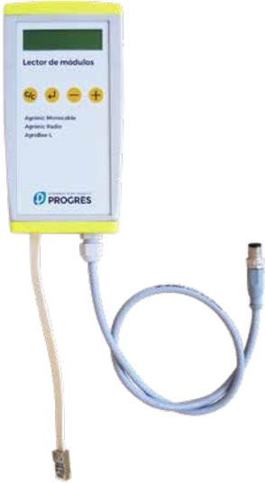
Del mismo modo, un módulo se tiene que configurar para comunicar con el Agrónico con el que se quiera asociar. Para ello (si el módulo no viene ya configurado de fábrica) hay que emplear el Lector de Módulos (ó Lector Agrónico Radio, LAR) consistente en una pantalla y cuatro teclas que se conecta al módulo AgroBee-L mediante el único conector visible en su interior.
