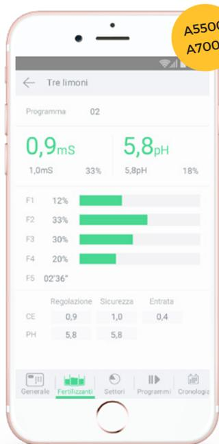
Valore della lettura del sensore e del riferimento stabilito
